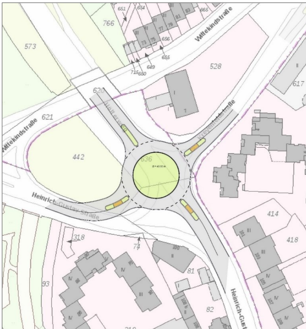
Bild 25: Gestaltungsvorschlag für den Umbau des Knotenpunktes Hölter Weg / Kreyenfeldstraße in einen Kreisverkehr und Umnutzung der Wittekindstraße als Fahrradstraße
